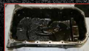
Sedimentos reales en el cárter.
