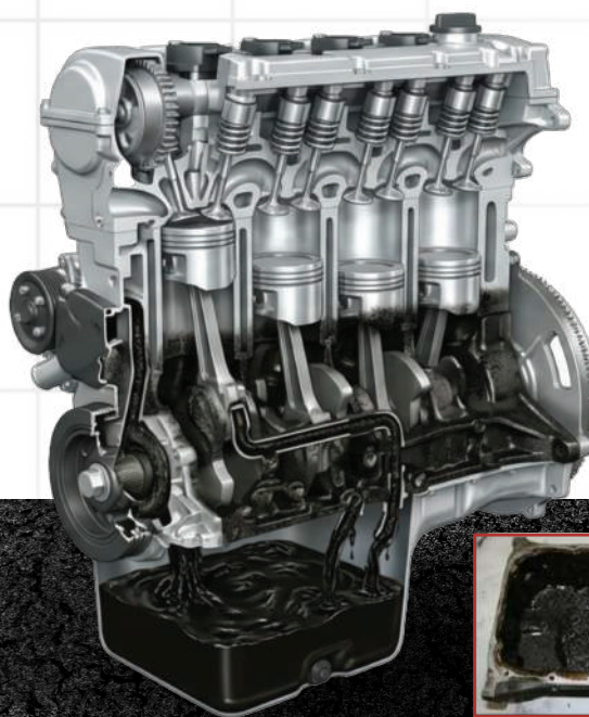
Sedimentos reales en el cárter.
